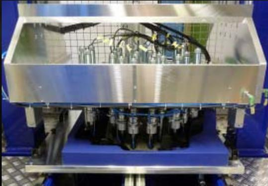
Durch kodierte Wechselwerkzeuge wird sichergestellt, dass die Maschine immer mit den zugehörigen Parametern betrieben wird.
