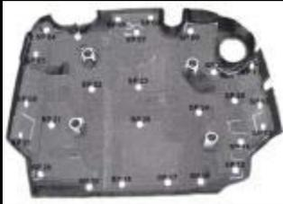
Mit einer Vielzahl von Schweißpunkten auf engstem Raum sind, abhängig von der Anzahl der Generatoren, Zykluszeiten von bis zu maximal 30 Sekunden erreichbar.
