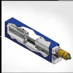
Diese Vorschubeinheit bietet eine sehr hohe Steifigkeit und ist für Hübe bis 100mm ausgelegt. Arbeitsfrequenzen von 30-35-40 kHz sind möglich. Auf Wunsch kann auch eine 20kHz Lösung angeboten werden.
