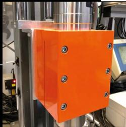
20kHz Aufnahmesysteme für Booster verschiedener Hersteller. Ob als Einzellösung oder in einer Sonderanlage findet das Spannsystem seine Verwendung.
