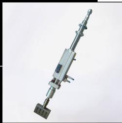
Vorschubeinheit/Sonderzylinder mit Hüben von 50 bis 320mm. Alle Anbaukomponenten können auf Wunsch geliefert werden. Die Kolbenstange des Zylinders ist mit einer Bohrung 16mm versehen, um das HF-Kabel zu führen.
